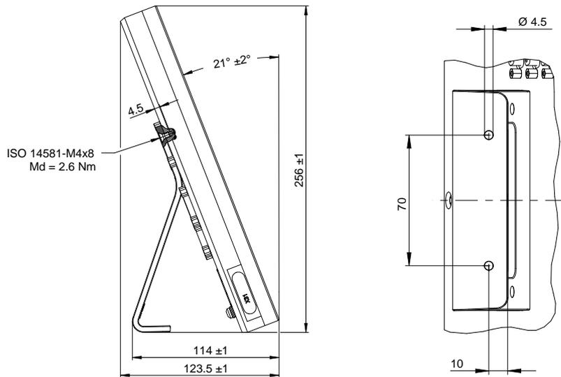
Illustration 68 : Dimensions de l'appareil avec le socle Single-Pos
