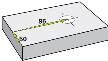
Illustration 33 : Exemple de pièce – Usinage d'un trou traversant
