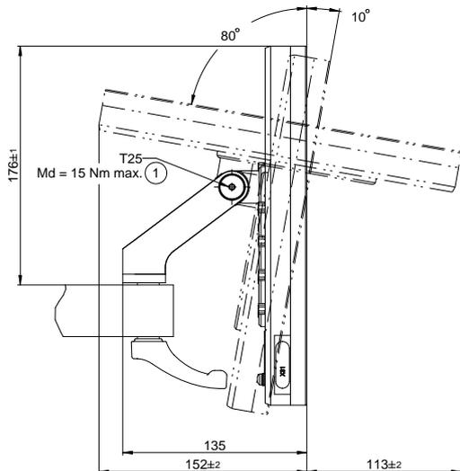
Illustration 71 : Dimensions de l'appareil avec le support Multi-Pos
