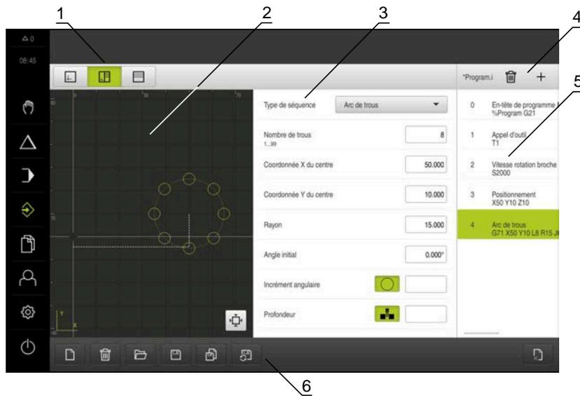
Illustration 20 : Menu **Programmation** avec fenêtre de simulation ouverte
