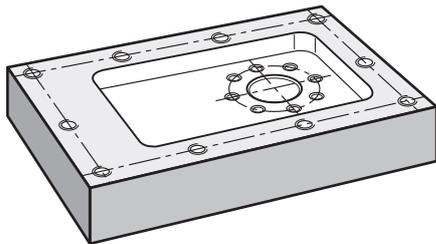
Illustration 37 : Exemple de pièce – Programmation d'un cercle de trous et d'une rangée de trous
