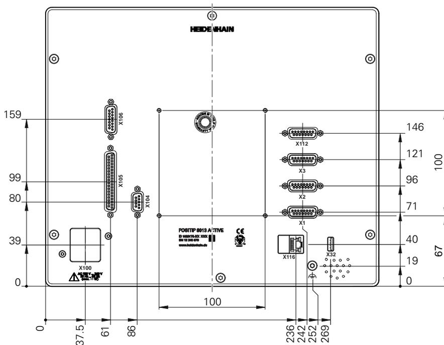
Illustration 65 : Dimensions de l'arrière de l'appareil
