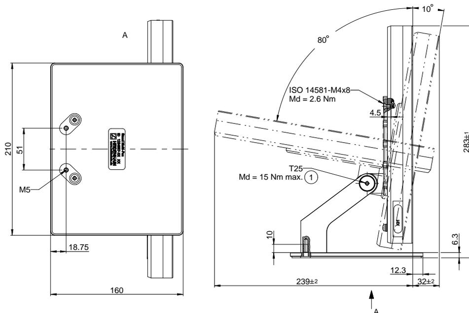
Illustration 70 : Dimensions de l'appareil avec le socle Multi-Pos
