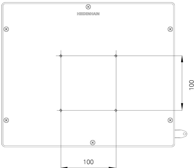
Illustration 1 : Dimensions de l'arrière de l'appareil
