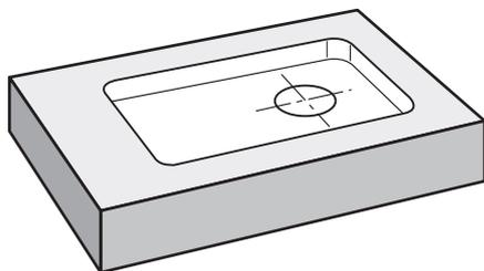
Illustration 34 : Exemple de pièce – Usinage d'une poche rectangulaire
