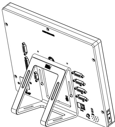
Illustration 4 : L'appareil monté sur le socle Duo-Pos
