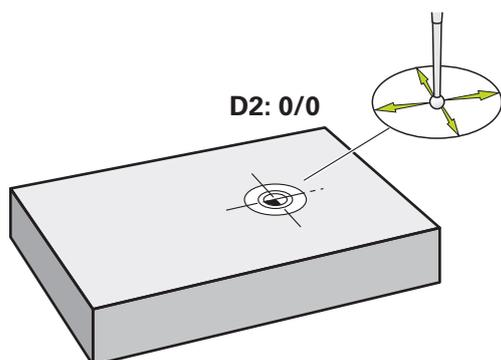
Illustration 36 : Exemple de pièce – Détermination du point d'origine D2
