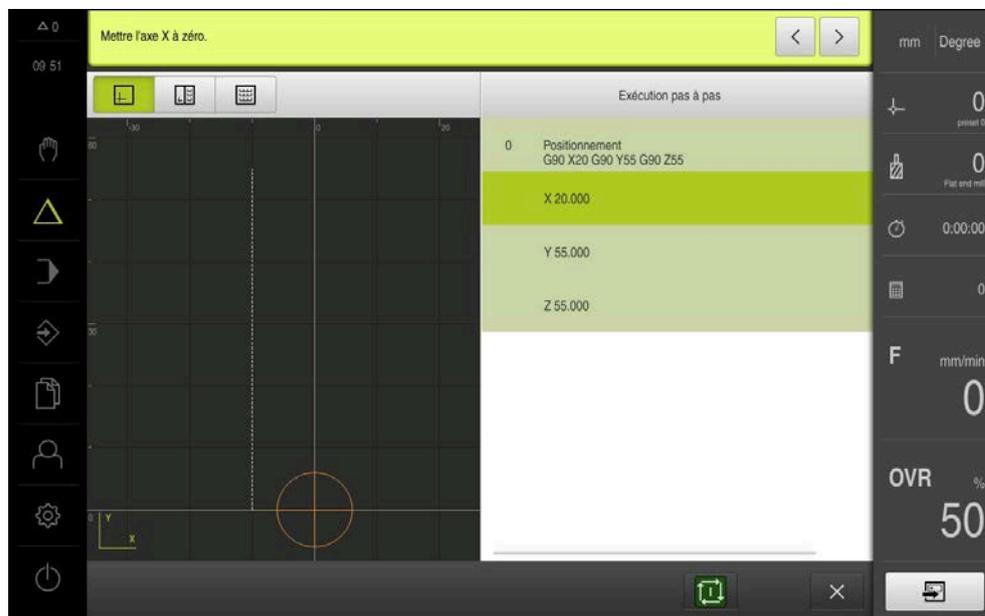
Illustration 50 : Exemple – Exécution d'une séquence MDI avec un facteur d'échelle
