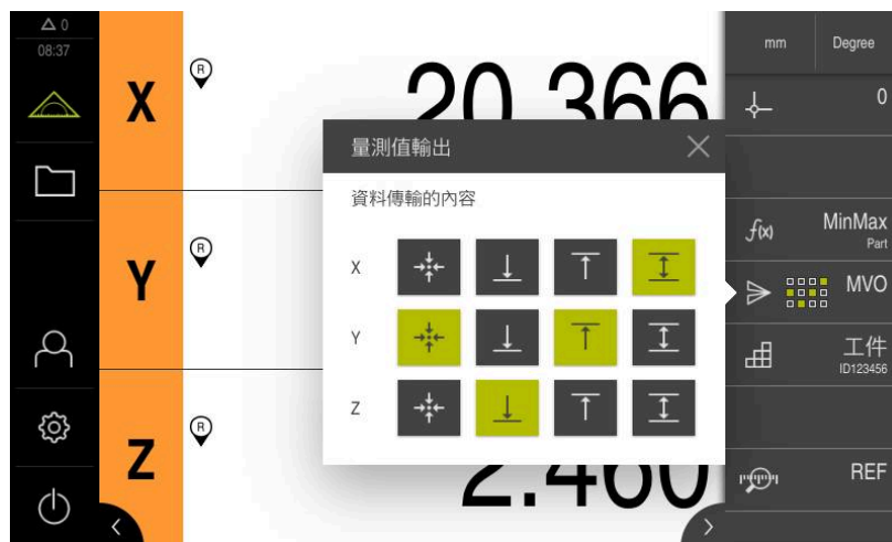
圖形 27: 選取內容顯示用於量測值輸出
